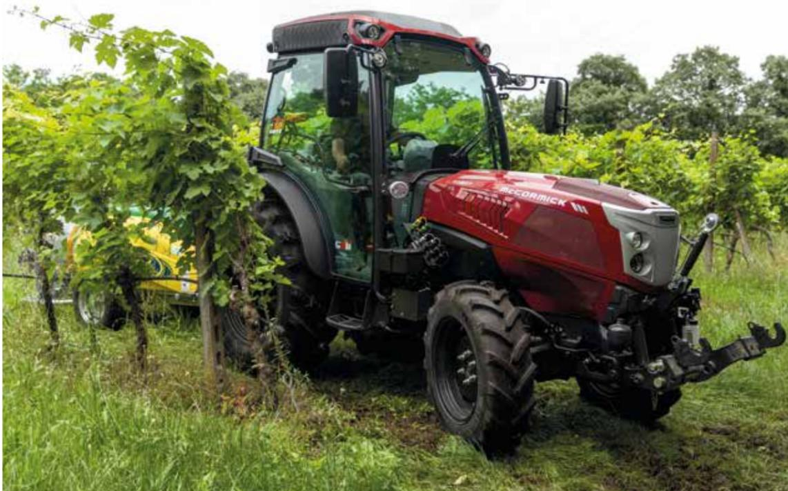
Die Modelle F, N und XL können mit einer gefederten Vorderachse für mehr Stabilität und Wendigkeit ausgestattet werden. Die gefederte Achse verleiht dem **X4F** auch in unwegsamem Gelände eine optimale Bodenhaftung. Auf dem Feld werden sowohl die Traktion als auch die Kontrolle des Traktors verbessert, während bei Transportarbeiten Geschwindigkeit, Sicherheit und Bedienerkomfort erhöht werden.
