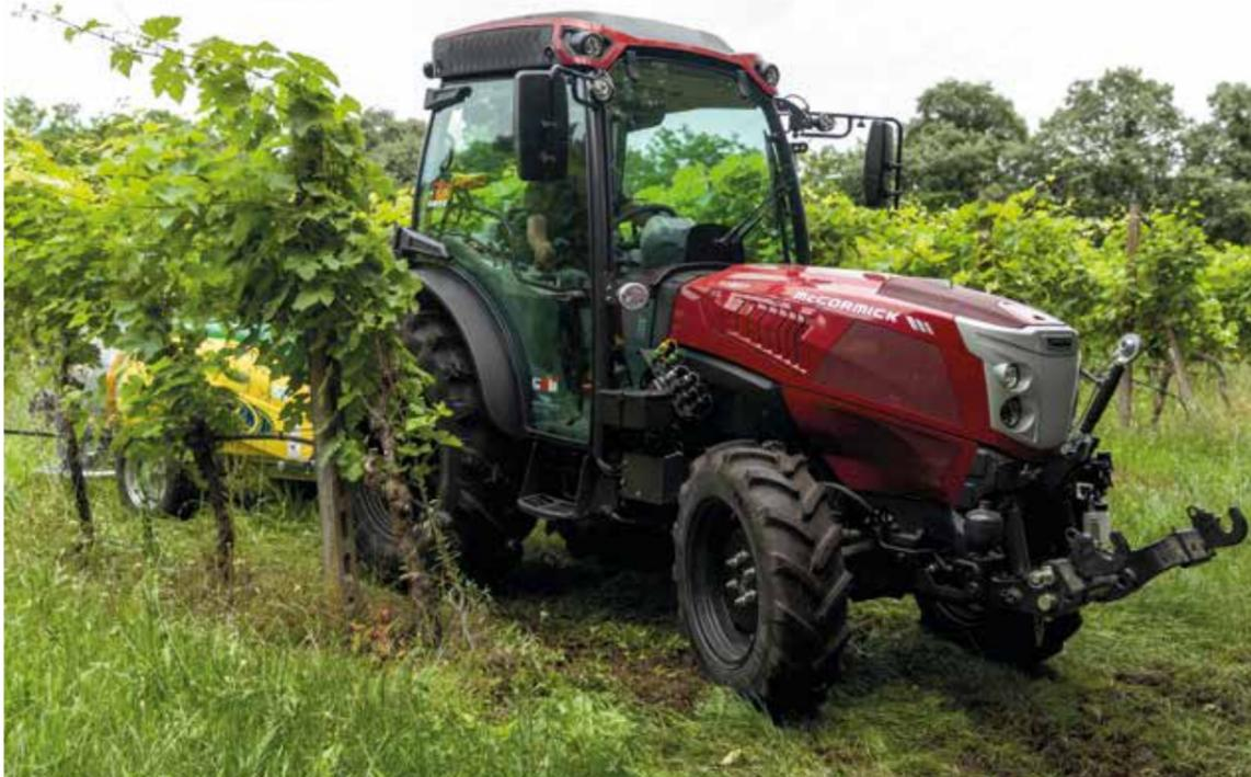
Los modelos F, N y XL pueden equiparse con un eje delantero suspendido para aumentar la estabilidad y agilidad. El eje suspendido garantiza al **X4F** la máxima adherencia al suelo, incluso en terrenos abruptos. En el campo, mejora tanto la tracción como el control del tractor, mientras que en los desplazamientos por carretera aumenta la seguridad, la velocidad y el confort.
