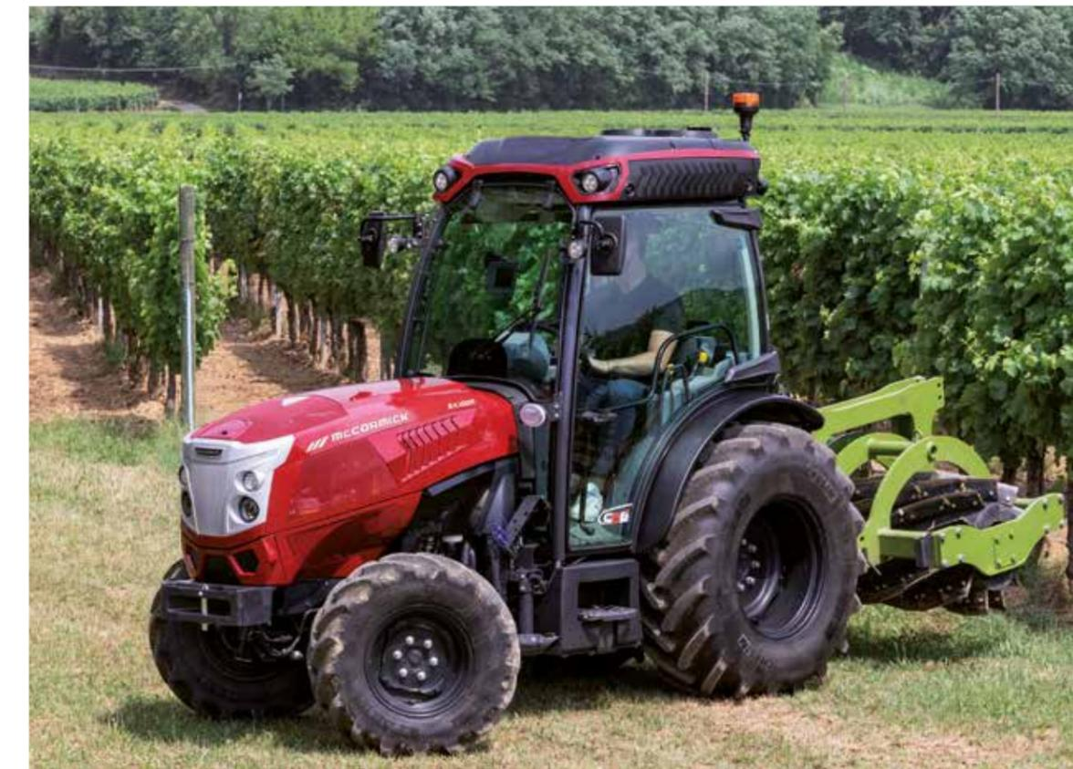
La transmisión Speed Four del X4F presenta 4 marchas sincronizadas y 3 gamas mecánicas, para un total de 12 AD + 12 MA. Con el superreductor, las gamas se convierten en 4, para un total de 16 AD + 16 MA. La transmisión Speed Four permite varias configuraciones:
