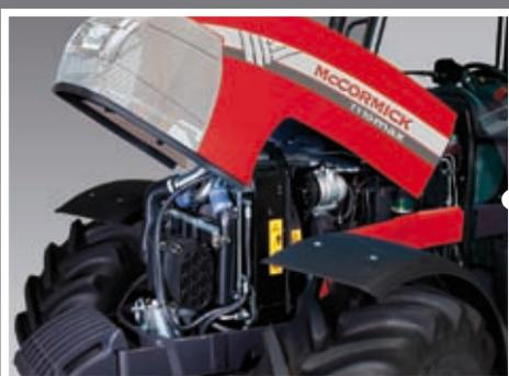
**Le moteur.** Le moteur Perkins à 4 cylindres offrent des solutions à l'avant-garde.
