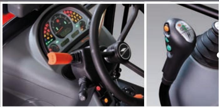
**Les commandes.** À gauche le levier de l'inverseur hydraulique au volant pour l'inversion de n'importe quelle vitesse sans utiliser la pédale de l'embrayage. À droite, le levier de la boîte de vitesses T-Tronic actionnant 3 gammes en Powershift (H-M-L) à l'aide des boutons verts.
